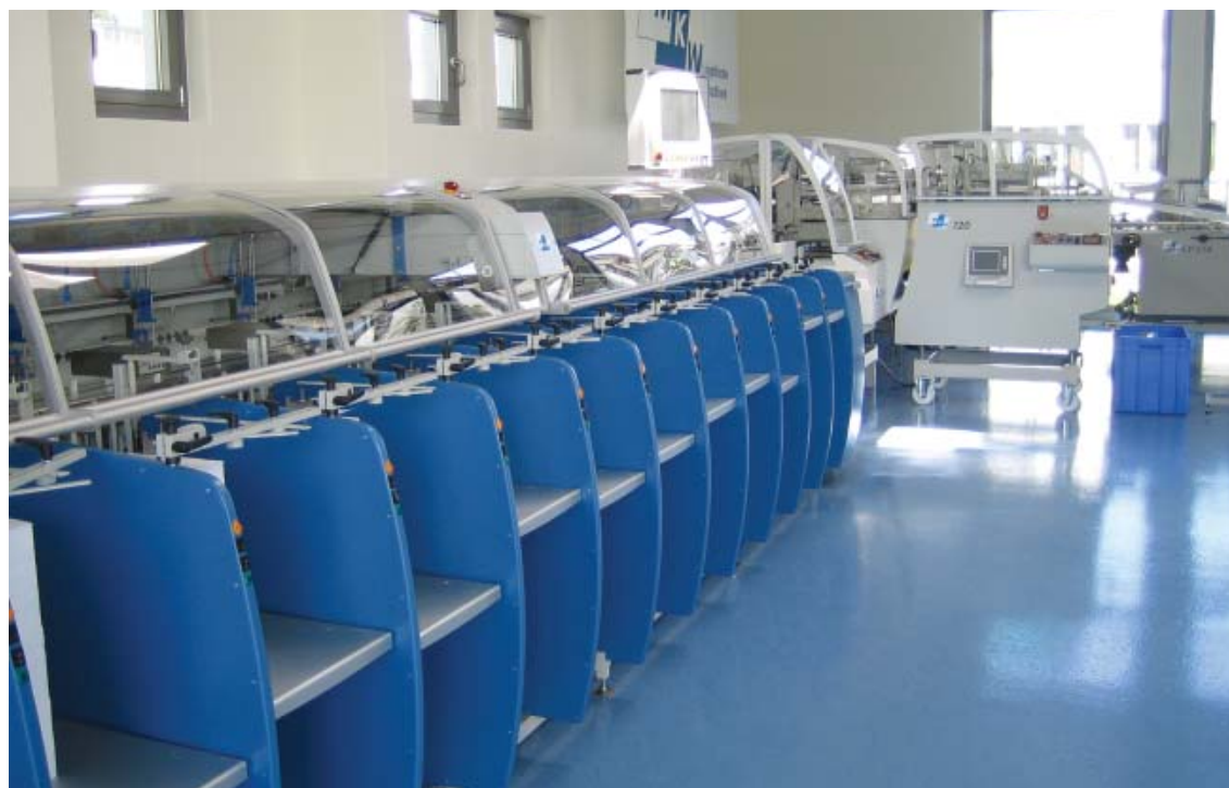
МКW Rapid UT GS, установленный в линию с фальцевально-брошюровочным модулем SFT-350
